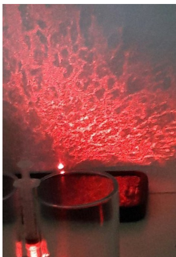
Figura 3: Células da mucosa bucal projetadas pelo microscópio caseiro
